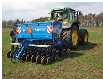
Fig.5: Equipment pour sursemis en ligne
