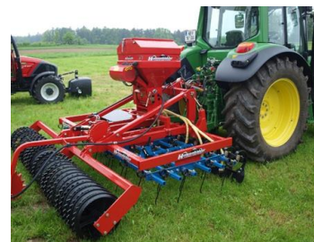
Fig.6: Equipment pour un sursemis à la volée suivi d'un rouleau Cambridge
