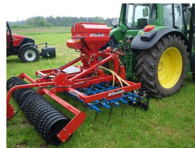
Fig.6: Machines voor grasland doorzaaien uitgerust met Cambridge-roller
