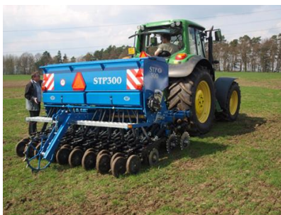
Fig.5: Machine geschikt voor het zaaien van sleuven
