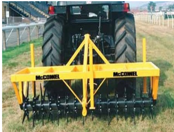
Fig.1: Esempio di aeratore o spiker/slitter
