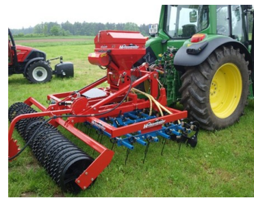
Fig.6: Macchinario per la trasemina dei prati dotata di rullo Cambridge
