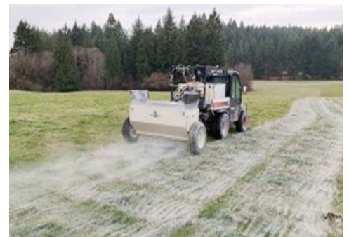
Abb. 3: Ausbringung von Kalk auf die Oberfläche von Grünlandböden mit Maschinen
