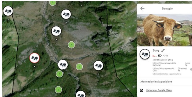
Abb. 2: Mit einem GPS-Halsband ausgestattetes Hochlandrind (links) und Echtzeit-Ortung der Kuh und der Herde (rechts) auf einer alpinen Sommerweide
