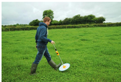
1. ábra: Emelkedőlemezés mérőműszer használata.
