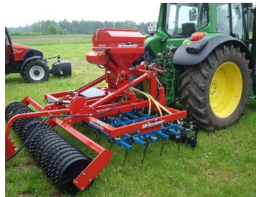
Sl.6: Mašine za sjetvu travnjaka opremljene Cambridge valjkom
