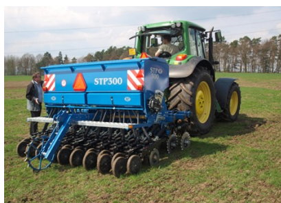
5. ábra: Sávos vetésre alkalmas gép
