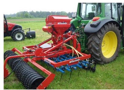
6. ábra: Cambridge hengerrel felszerelt gép a gyepfelület felülszántására
