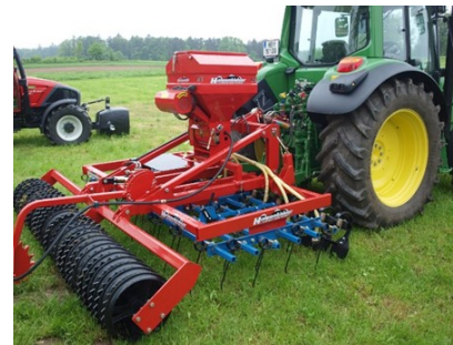
Abb.6: Maschine zur Grünlandübersaat mit Cambridge-Walze
